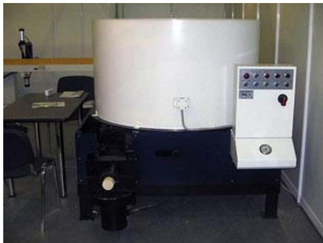
Брикетировочный пресс предназначен для изготовления брикетов из древесной щепы и опилок, которые могут применяться в качестве топлива как в промышленных отопительных системах, так и индивидуальном хозяйстве. При прессовании получают очень компактный брикет без добавления вяжущих веществ.
